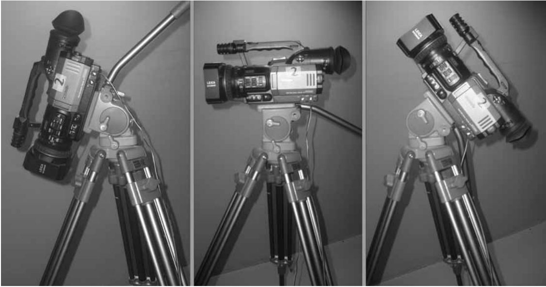
Fig. 3.29. Las dos figuras de los extremos nos muestran la consecuencia de dejar flojo el seguro de amarre. Al centro, la forma correcta como deben quedar las cámaras después de una práctica o producción, bien aseguradas.
