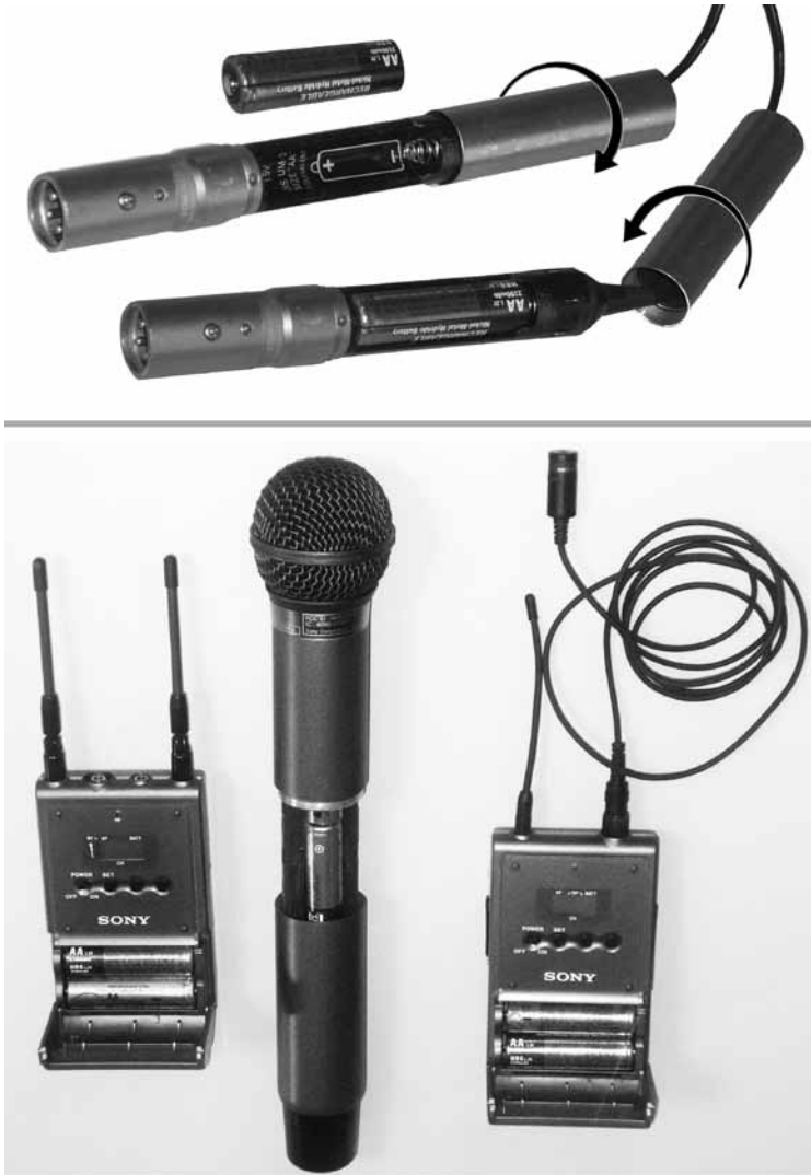
Fig. 5.14 Los micrófonos que requieren de baterías “AA” para su funcionamiento deberán ser revisados antes de ser conectados para asegurarse de que las baterías están colocadas y en buen estado en el compartimiento respectivo.
