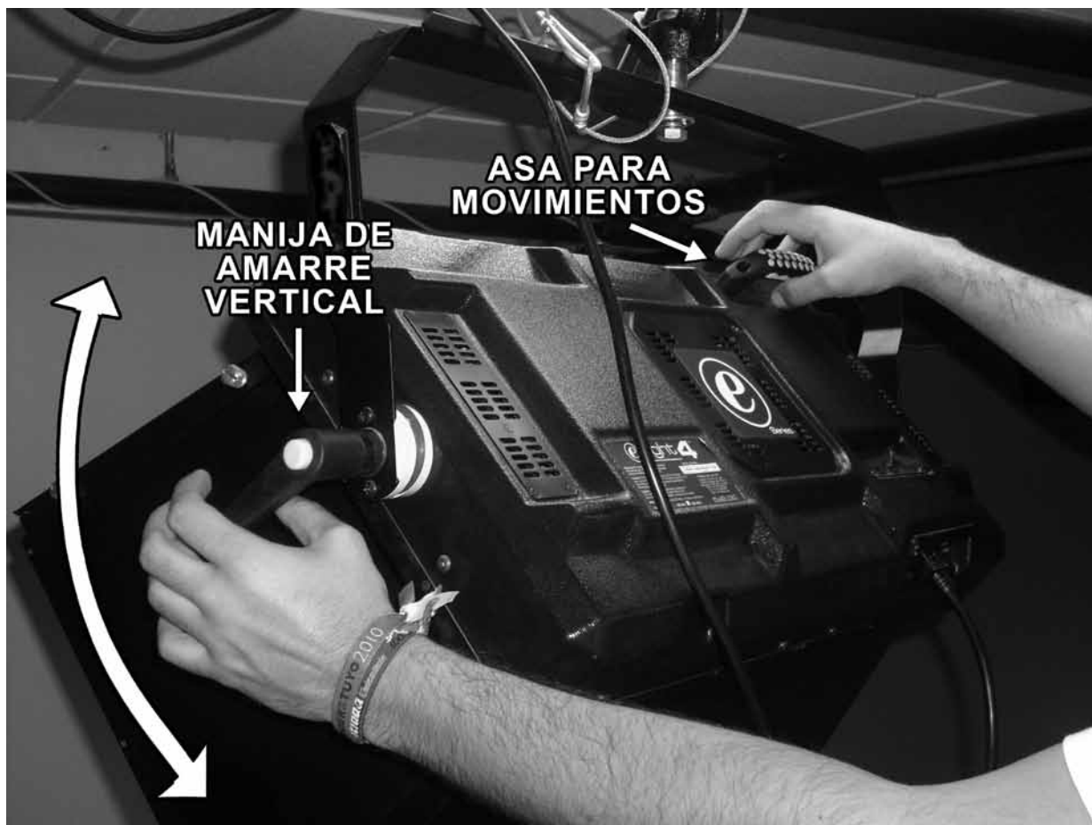
Fig. 4.17. El otromovimiento es el giro vertical. Antes de realizarlo se deberá aflojar ligeramente la manija de amarre vertical, sosteniendo con la otra mano por el asa y entonces efectuar el giro de la luminaria hacia arriba o abajo, según se requiera. Luego, se aprieta de nuevo y suavemente la manija.
