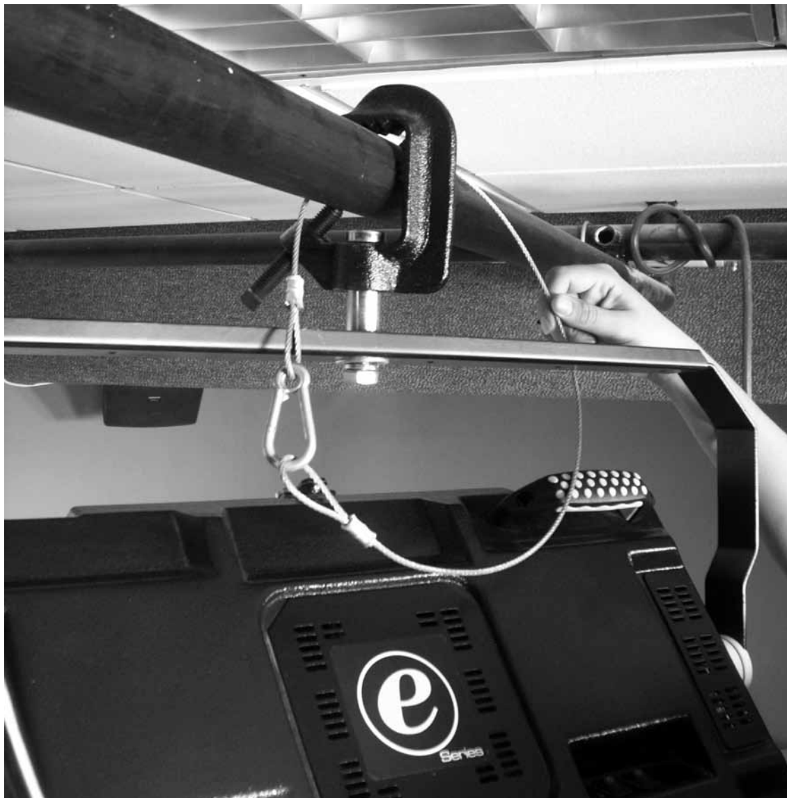
Fig. 4.18. Siempre que se realice alguno de los movimientos de giro horizontal o vertical antes descritos, el cincho deberá permanecer cerrado, aún después de que el tornillo o la manija hayan sido de nuevo apretados. No hay que olvidar que el cincho asegura que no se caiga la unidad, en caso de que se le llegara a soltar involuntariamente a quien la está manipulando en ese momento.
