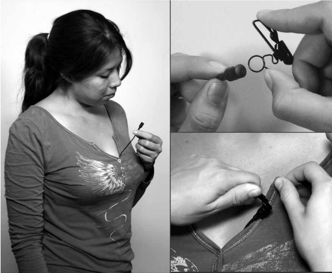
Fig. 5.16. El microfonista coloca la pinza al micrófono y lo sujeta a la solapa o escote de la usuaria a una distancia de entre 15 a 20 centímetros debajo de la barbilla, encima de la ropa, evitando lo que pudiera rozar o golpear contra él.
