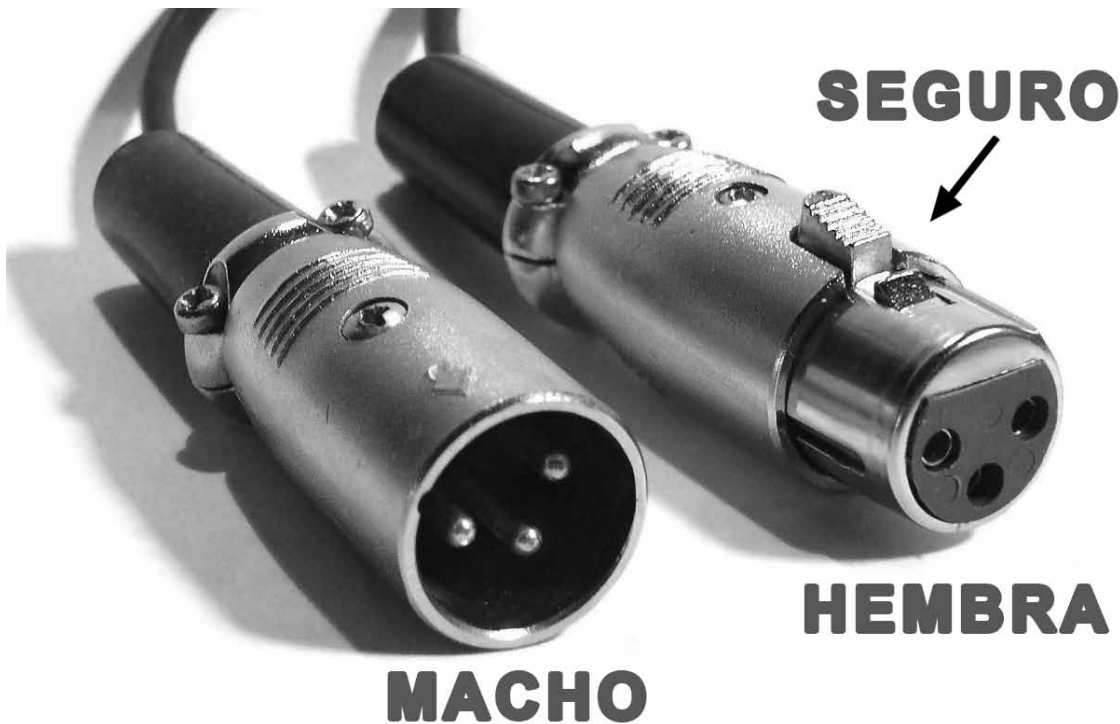
Fig. 5.3 Conectores XLR o tipo Cannon, para audio. A la izquierda, el conector macho que proviene del micrófono; a la derecha, el conector hembra de la línea de audio al máster.
