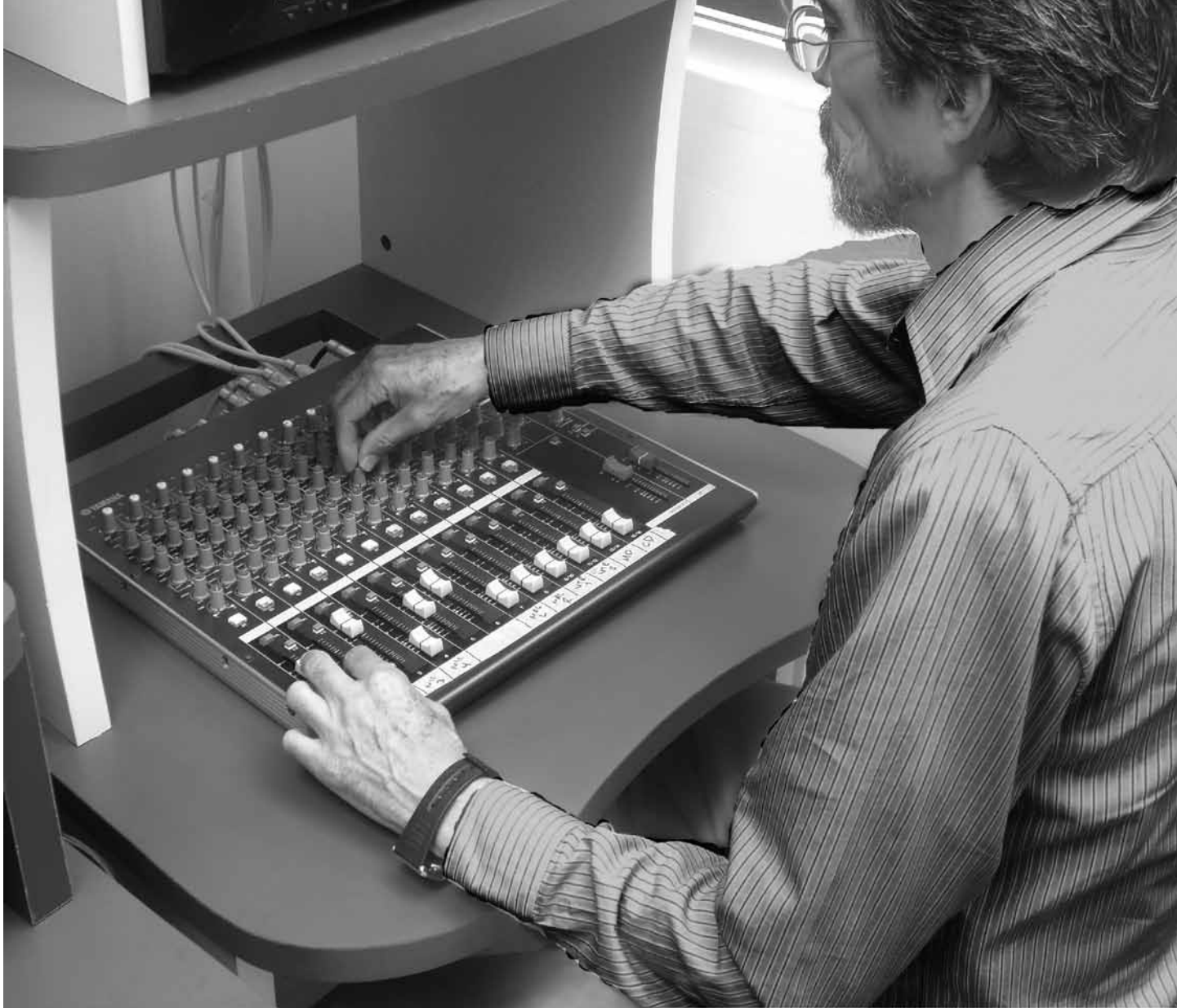
Fig. 6.10 Operador de la consola de audio ecualiza (graves-agudos) y establece los niveles adecuados (volumen) de las distintas señales de audio que llegan a la mezcladora.
