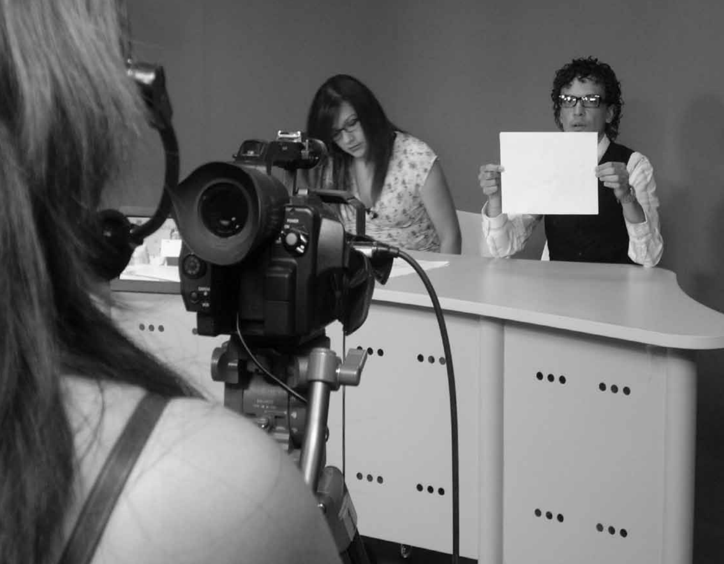
Fig. 3.21 El operador de cámara realiza el balance a blancos enfocando sobre una hoja blanca
